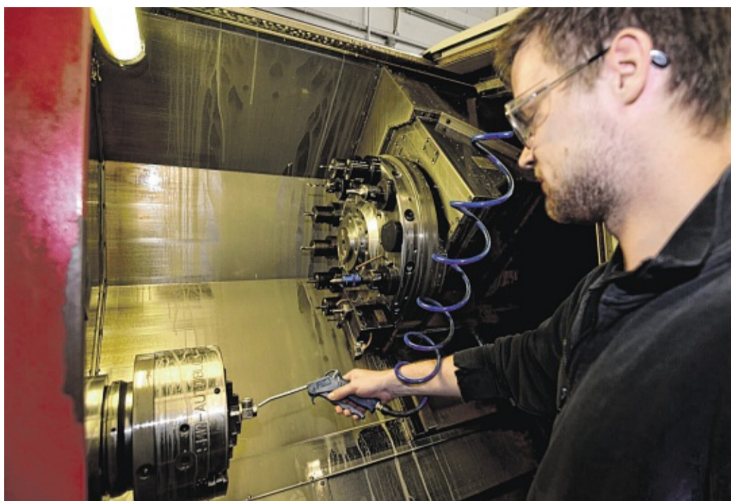
Zwischen den einzelnen Arbeitsschritten muss Azubi Thorge Harms Späne aus dem Werkstück entfernen, das in der Drehmaschine bearbeitet wird.
